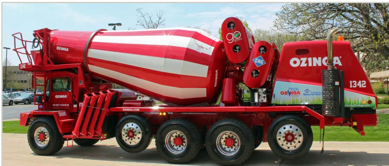
FRONT-DISCHARGE CNG CONCRETE MIXER (RETROFIT)
