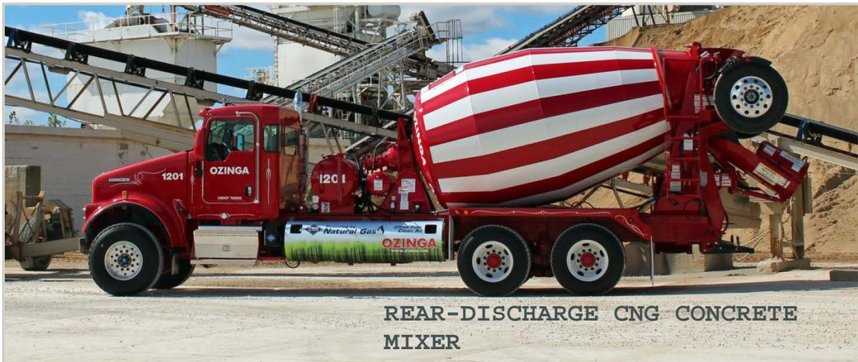
REAR-DISCHARGE CNG CONCRETE MIXER
